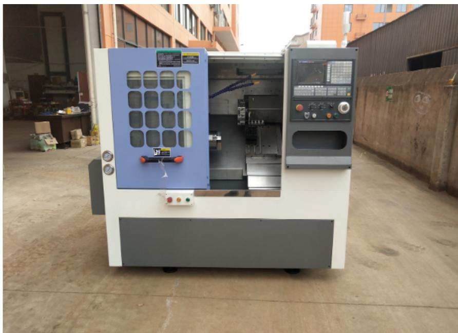
斜轨机床偶发的停机故障，这种情况的发生与两种原因有关：如果在斜轨机床断电后重新通电后故障便会消除，便是斜轨机床的某些特定的操作与功能运行组合下，引发了相关软件在设计中的 BUG 而导致。另一种是斜轨机床在湿度过大。在我国部分地区，斜轨机床常常被置于厂房大门附近，在斜轨机床运行时长时间开着斜轨机床电源柜的门，附近空气中的大量粉尘、金属碎屑或者水雾便进入其中，从而影响到电源设备的正常工作。斜轨机床主轴伺服系统的主轴速度异常原因有多种可能，首先，数控斜轨机床的机械传动部位的变速系统可能产生异常，必须对其进行重新调整。其次，便是主轴驱动器的电缆连接中断或者驱动器的状态指示灯损坏，必须对电缆加以重新连接或者更换指示灯。再次，便是斜轨机床控制柜中的位置控制板输出信号的稳定性变差所致。如果上述问题均可排除，可以再对控制板加以进一步的查看。合肥五轴微型数控斜轨机床斜轨机床制造者关心的莫过于斜轨机床的精度，刚性和使用寿命。
